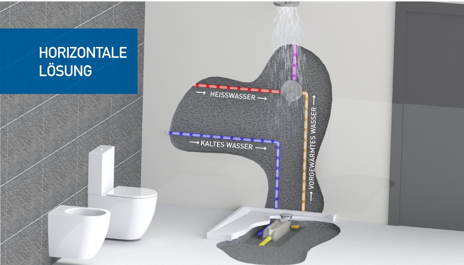
ZYPHO überträgt die Wärme des Abwassers der Dusche (40°) auf die eingehende Kaltwasserleitung (10°). Dieses vorgewärmte Wasser (bis zu 31°) wird dann entweder der Duscharmischerie, dem Warmwasserbereiter oder - vorzugsweise beiden - zugeführt, wodurch der Energieverbrauch von 30% bis 67% gesenkt und die Energieeffizienz verbessert wird. Bei drei Duschen sind zwei davon kostenlos.
